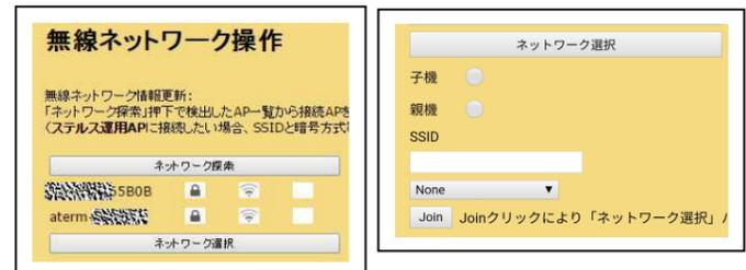
上図のように検出できた無線LANの親機（アクセスポイント）のSSIDが表示されます。接続したいSSIDをクリックしてください。「ネットワーク探索」で接続したいSSIDが出てこない場合、「ネットワーク選択」で子機にチェックし、SSIDを入力、パスワードの方式を選択しJoinをクリックしてください。
