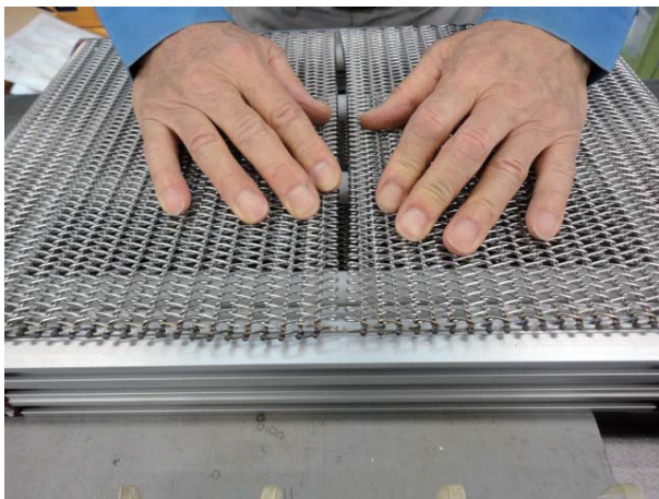
メッシュベルトのエンドレス部の間隔をつめてください。
