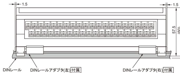
DINレール DINレールアダプタ(左)〔付属〕 DINレールアダプタ(右)〔付属〕
