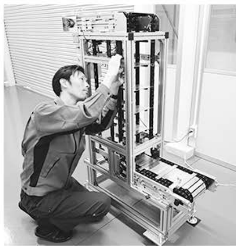
立体搬送コンベアモジュールを調整する荒木悠平氏
