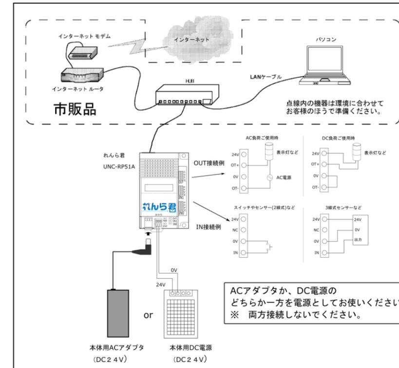
2. 接続が完了したら、れんら君に電源を入れてください。電源投入直後 PWR\_LED が赤点灯した後、PWR\_LED : 緑点灯、STAT\_LED : 緑点灯の状態となります。この時、PWR\_LED : 赤点灯になっている場合、何らかの異常が発生していますので再度接続をご確認頂き、一度電源を切り再投入してください。
