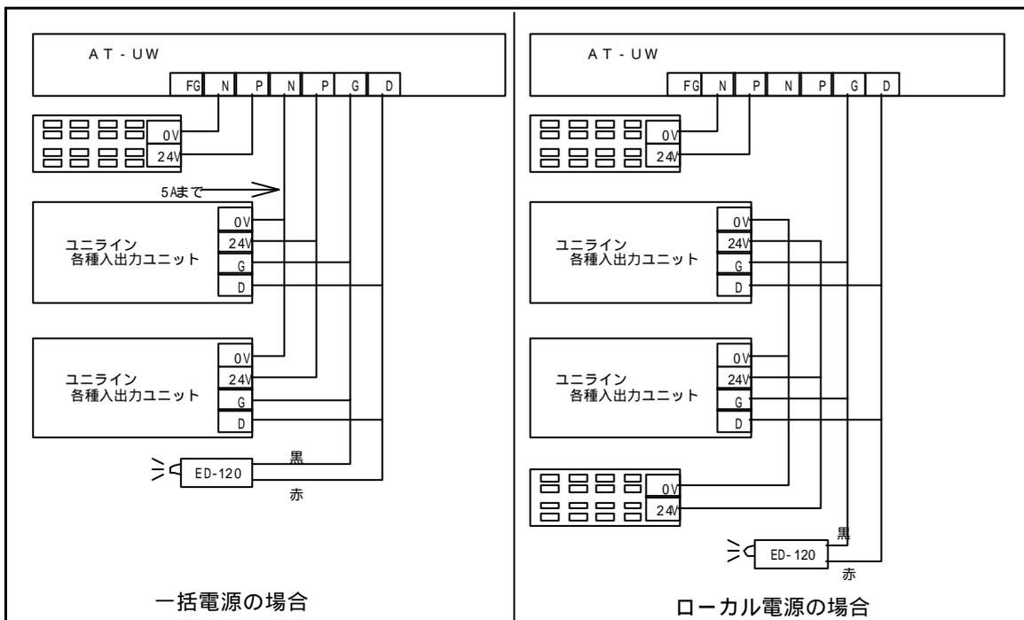
一括電源の場合ボード内を通じて供給することになるため、ターミナルに供給する24V電源はセンサや電磁弁など負荷用を含め5Aまでとしてください。
