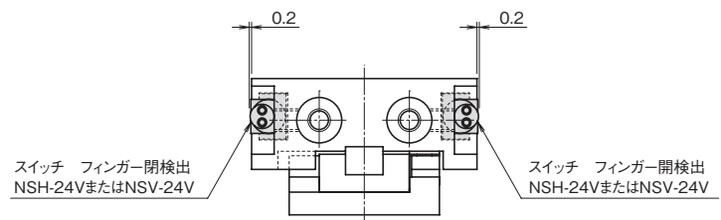
(注1) SH1, SV1の場合は、スイッチを上図のフィンガー開検出位置に取り付けてあります。フィンガー閉を検出するには付け換えてください。
