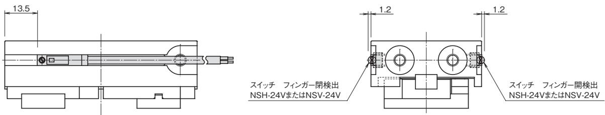
(注1) SH1, SV1の場合は、スイッチを上図のフィンガー開検出位置に取り付けてあります。フィンガー閉を検出するには付け換えてください。
