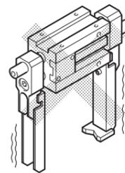
(2) フィンガー⑳(㉓)を開いて、片側ずつスプナや手で押さえ、アタッチメント取付タップ×2カ所を使用してボルトを締め、アタッチメントを固定してください。
