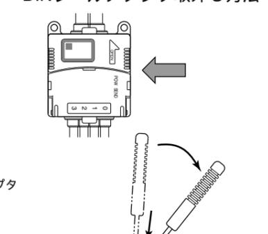
矢印の位置にマイナスドライバーを差し込み、ドライバーを倒し本体を取り外してください。
